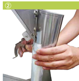
② ホッパーの後部にあるフックに専用袋を取り付けます。袋の開口部が密着(ブロッキング)して開きにくい場合があるので、一度開口部を軽くもみほぐしてから袋をセットしてください。
