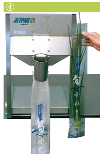
④ 袋本体がミシン目から外れて作業完了です。次の袋が自動的に開きます。
